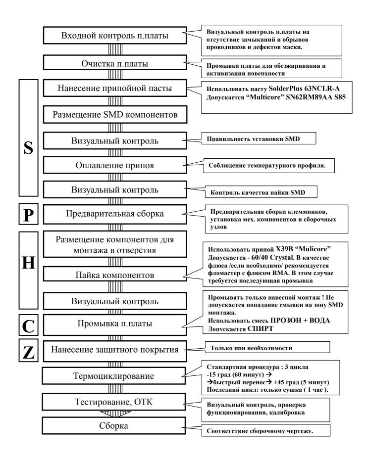
Латинские буквы слева от названий технологических этапов служат для описания в конструкторской документации полного технологического цикла конкретного изделия. Обязательные этапы не указываются. Например, для платы ххх следует указать: "плату изготовить по типовому процессу с пропуском этапов C, Z."
