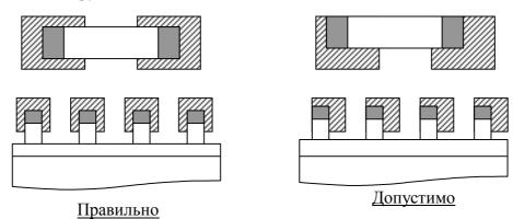
◆ Микросхемы с более мелким шагом. Новые микросхемы процессоров и памяти имеют, как правило, шаг выводов 0,65-0,8мм и большое количество выводов на 2 или 4 стороны. При ручном позиционировании для вспомогательной фиксации компонентов используется специальная мастика. Выводы паяются при помощи фломастера с флюсом NC или RMA и наконечника "микроволна" паяльной станции. При пайке групповым методом требуется применение тонкого (0,3мм) наконечника для диспенсера.
