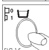
**Кнопка выключения центрифуги:** Нажимая на кнопку выключения центрифуги, стиральная машина выполняет цикл стирки без отжатия белья. Если кнопка находится в положении 1, машина не включает центрифугу, а если кнопка находится в положении 0, будет осуществлена также и центрифуга (рис. 16).
