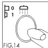
**Кнопка задержания воды в барабане:** Использовать только для стирки синтетических тканей. Нажимая на кнопку задержания воды в барабане (рис. 15), стиральная машина автоматически останавливается в начале последнего полоскания, а погруженное в барабан с водой белье не мнется. Функция доступна при одновременном нажатии кнопки для выключения центрифуги.
