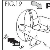
**ВНИМАНИЕ: Не поворачивать ручку программирующего устройства против часовой стрелки (рис. 19). Если случайно ручка программирующего устройства окажется дальше выбранной программы, ее нельзя поворачивать назад, а продолжать крутить вправо, пока она не окажется в нужном положении.**
