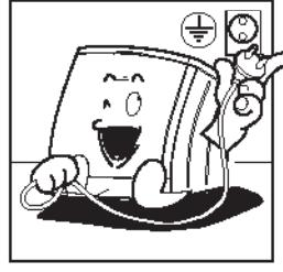
Стиральная машина должна быть подключена к электрической сети с заземлением согласно правилам техники безопасности.
