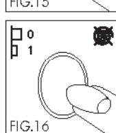
**Кнопка частичного наполнения барабана:** Если вес белья не превышает 2,5 кг, нужно нажать кнопку частичного наполнения. Эта функция уменьшает количество воды, используемой во время стирки. Машина выполняет эту функцию при одновременном положении кнопки 1 (рис. 17).
