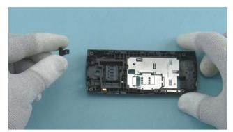
37) Pull out and remove the MICRO USB DOOR.
