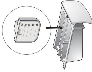
В случае применения порошков для стирки, вкладыш можно установить на боковой стенке камеры **С** в предназначенном для этой цели выемке (рис. 30)
