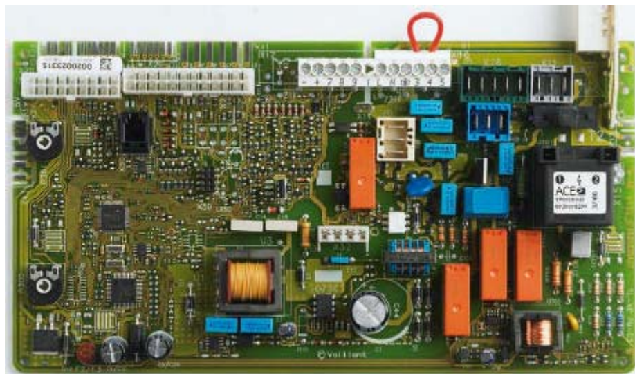
Электронная плата котла
