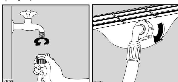
Другой конец наливного шланга, подключающийся к машине, может быть повернут в любом направлении. Ослабьте гайку, поверните шланг и вновь затяните гайку, проверив отсутствие течи воды. Наливной шланг нельзя вытягивать. Если он слишком
