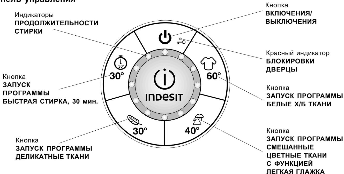
Кнопка **ВКЛЮЧЕНИЯ/ВЫКЛЮЧЕНИЯ**: служит для включения и выключения машины.
