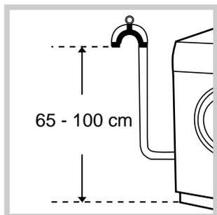
Подсоедините сливной шланг, так чтобы он не был изогнут, к сливному трубопроводу или сливному отверстию в стене, расположенному на высоте 65-100 см от пола.
