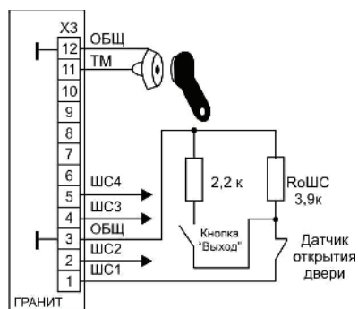
Рис. 7 Подключение цепей управления доступом
