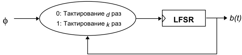
Рис. 16-13. Самопрореживающий генератор Рюппела.
