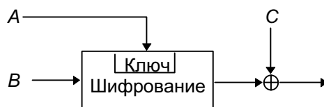
Рис. 18-8. Обобщенная хэш-функция, у которой длина хэш-значения равна длине блока
