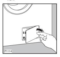
Notentleerungsschlauch aus seinem Sitz herausnehmen, Auffanggefäß unterstellen und Verschlussstopfen des Schlauchs herausziehen.
