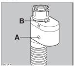
Hinweis! Lockerungssicherung "B". Bei einigen Modellen ist der Wasserzulaufschlauch mit einem gelben Sicherungsknopf (B) ausgestattet. Dieser muss zum Abschrauben des Schlauches gedrückt werden.
