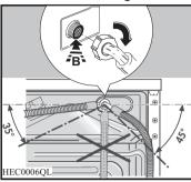
Ziehen Sie die Ringmutter nach dem Positionieren des Zulaufschlauchs wieder fest, um Wasseraustritt zu vermeiden.
