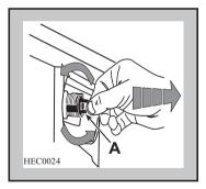
2 Schließen Sie den Schlauch mit dem Winkelverbindungsstück an die Maschine an.
