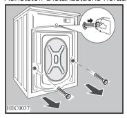
**5**Verschließen Sie die Öffnungen mit den Kunststoffabdeckungen, die sich im Beipack befinden.
