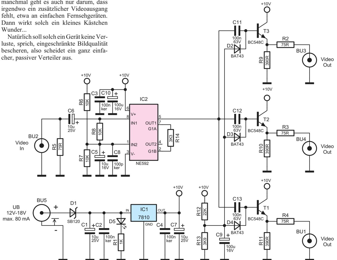
**Bild 2: Schaltbild des Videoverteilers VV 3**
