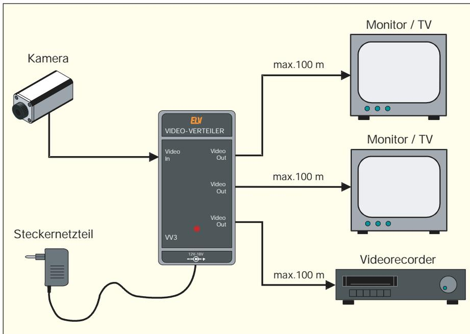
**Bild 1: Anschlussmöglichkeiten des VV 3**
