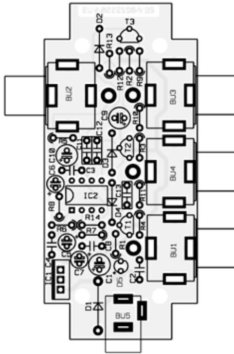
Ansicht der fertig bestückten Platine des Videoverteilers VV 3 mit zugehörigem Bestückungsplan
