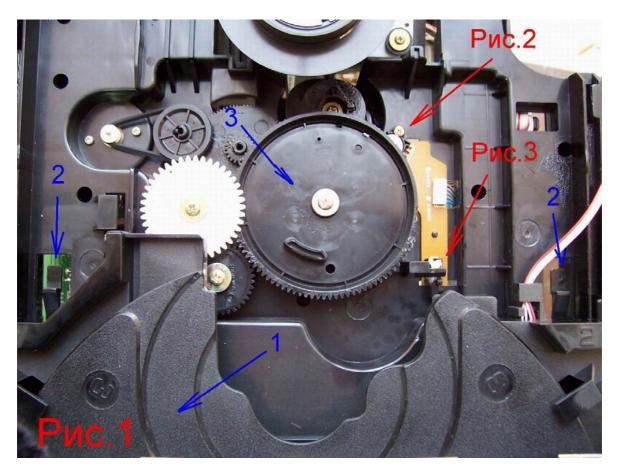
Крутящийся лоток-1 должен полностью быть выдвинутым за защелки -2 чтобы программную шестерню-3 можно было без проблем крутить и поставить в правильное положение Puc.4
