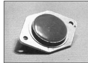
При температуре до 100 °С прочность, диэлектрические характеристики и удельное объемное сопротивление материала практически не изменяются. Диэлектрическая проницаемость  $\epsilon$  и тангенс угла диэлектрических потерь  $\text{tg } d$  мало чувствительны к изменению частоты, что позволяет использовать материал в высокочастотной технике. При возрастании частоты от 100 до 108 Гц  $\text{tg } d$  изменяется от  $3,0 \times 10^4$  до  $9,5 \times 10^4$  при  $\epsilon = \text{const}$ .
