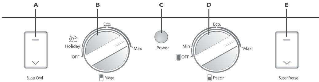
A – кнопка включения режима быстрого охлаждения (обозначение на панели управления SUPER COOL)
