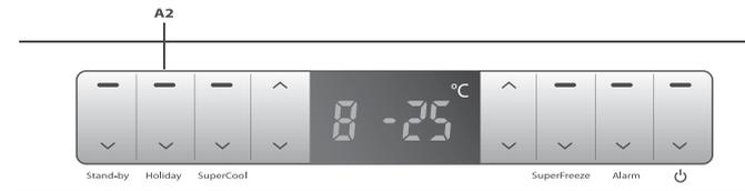
При активированном режиме Отпуск вы можете устанавливать режимы быстрой заморозки и быстрого охлаждения. В последнем случае режим Отпуск будет автоматически отключен.
