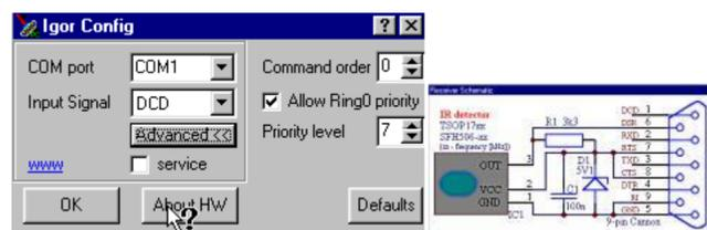
Настройки плагина просты: указание порта и даже разводка сигнального вывода. На тех схемах, которые я давал - он на DCD, по умолчанию стоит другой - поэтому обратите внимание. Больше ничего менять не нужно, плагин должен заработать сразу. Для тех, у кого вообще и схемы-то нету, есть кнопочка "about HW" - там как раз и схемка показана. Так что, остается один Girder, а Winlirc уже не нужен.
