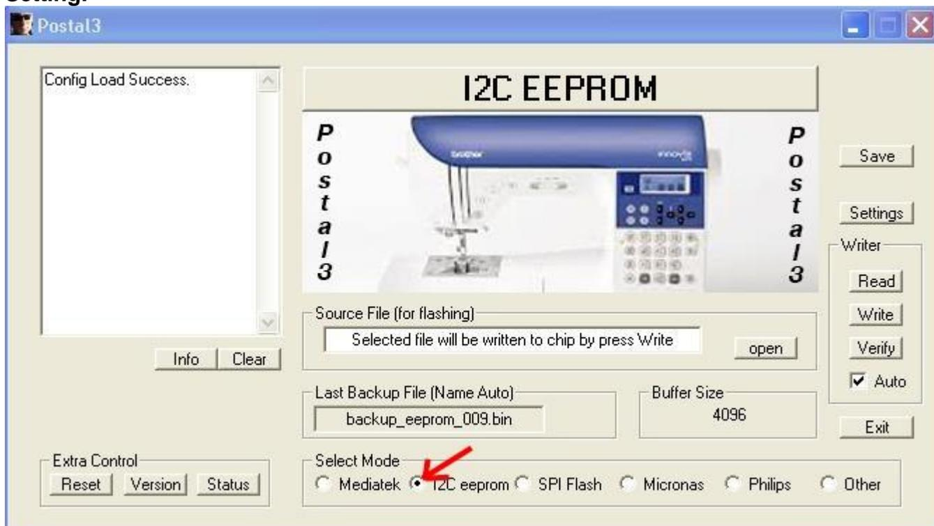
Режим **Auto Size** очень удобен, так как программа сама определит размер EEPROM, с которой будет работать, но можно выбрать и ручную. На картинке вы видите ручной выбор микросхемы памяти, если нужно автоматом, ставим галку возле **Auto Size**.
