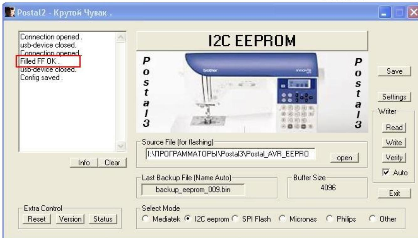
Микросхемы **I2C EEPROM** основаны на технологии '**EEPROM**'. При перепрограммировании микросхемы, предварительное стирание не требуется. Операция стирания, т.е. запись во все ячейки **FF** потребуется вам в том случае, когда нужно вставить в аппарат чистую микросхему.
