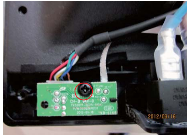
如图所示拆除遥控板螺丝
