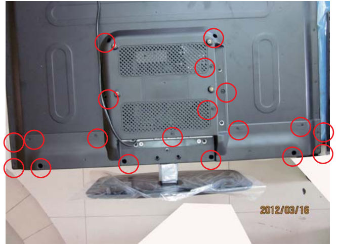
如图所示拆除后盖18个螺丝， (后盖有三种螺丝，在装卸时请注意)
