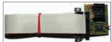
Рис. 3. Отладочная плата MSP-FET430X110
