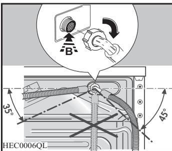
3 Stellen Sie den Schlauch durch Lockern der Ringmutter richtig ein. Ziehen Sie die Ringmutter nach dem Positionieren des Zulaufschlauchs wieder fest, um Wasser Austritt zu vermeiden.
