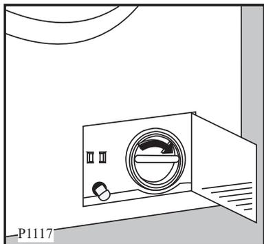
7. Die Grobkörperperle einsetzen und den Deckel im Uhrzeigersinn wieder fest verschrauben.
