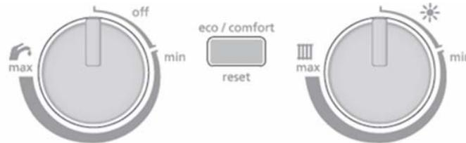
Поверните ручку «Отопление» в положение Макс., затем поверните ручку «ГВС» 3 раза от упора до упора.
