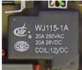
Реле служит для уменьшения тока при КЗ (защита) и включения аппарата на сеть после зарядки электролитов
