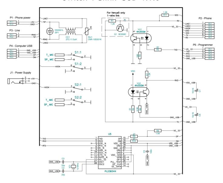
2. Схема подключения платы Switch PCLink к плате Venus5.
