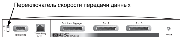
Рис. 2.1 Переключатель скорости передачи данных в сети Token Ring сервера печати J3264A в положении 16 Мбит/сек.
