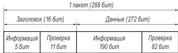
Рис. 1.37. Структура сопутствующей информации в скремблированном сигнале
