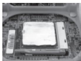
Рис. 1. Для улучшения теплопроводности между процессором и теплоотводом нанесите на верхнюю поверхность процессора термопасту или термопленку.
