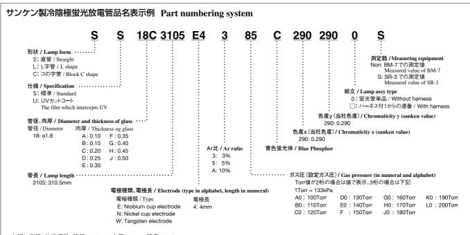
上記は直管、仕様標準、管径 $\phi$ 1.8mm、肉厚0.2mm、管長310.5mm、Nb4mm電極、Ar比3%、ガス圧85Torr、新BAM青色蛍光体、色度x=0.290、y=0.290、ハーネス無、SR-3で測定となります。
