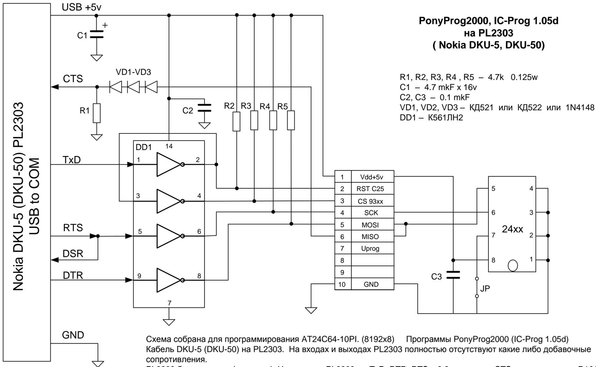
Схема собрана для программирования AT24C64-10PI. (8192x8) Программы PonyProg2000 (IC-Prog 1.05d)
