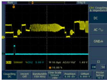
Подключите композитный или Y видео сигнала на входной разъем. Когда путь thorough видеосигнал на любое другое оборудование, internal резистор termination должна быть отключена. Триггерный выход подключен к осциллографу, как источника запуска (рост край).
