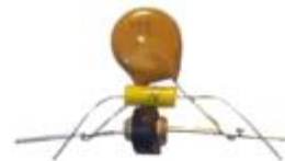
Диодная сборка с конденсатором
