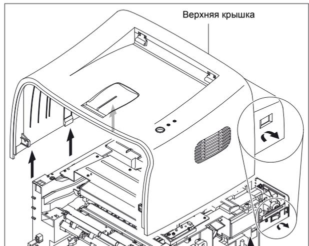
6. Снимите заднюю крышку с верхней крышки.
