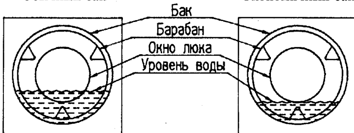
Рис. 2. Уровень заливки воды в баках различной конструкции
