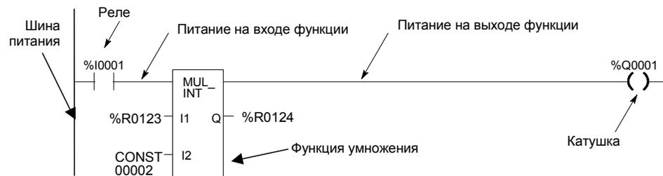
Прохождение логического питания через каждое звено управляется набором простых команд, которые работают как механические реле и выходные катушки. Пропустит ли реле питание логики через звено или нет, зависит от содержимого ячейки памяти, с которой реле связано в программе. Например, реле может пропустить питание, если оно связано с ячейкой памяти содержащей значение 1. Это реле не пропустит питание, если ячейка памяти содержит значение 0.
