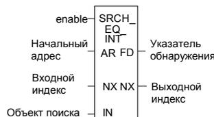
Поиск продолжается, пока не будет найден элемент массива просматриваемого объекта (IN) или пока не будет достигнут конец массива. Если элемент массива найден, указатель обнаружения (FD) устанавливается в 1, а индекс выхода (выход NX) устанавливается в относительную позицию этого элемента в массиве. Если элемент массива не найден до достижения конца массива, указатель обнаружения (FD) и индекс выхода (выход NX) устанавливаются в 0.
