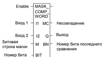
Когда функция получает питание, она начинает сравнивать биты первой битовой строки с соответствующими битами второй битовой строки. Сравнение продолжается или до обнаружения несоответствия, или до окончания строки.
