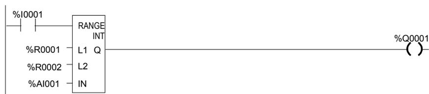
Выходная катушка %Q0001 включена, только если значение %AI001 находится внутри диапазона от 0 до 100.
